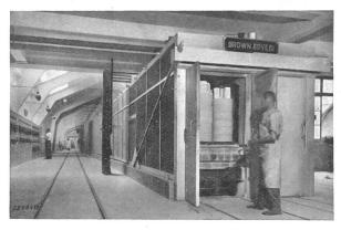
Fig. 1. Porzellan-Hartbrennofen in Langenthal. Links Scharfbrandteil, rechts Glühofen.
