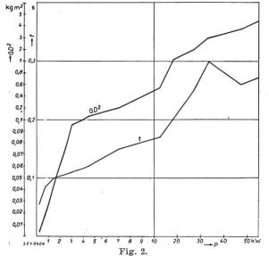
$GD^2$  und Eigenanlaufzeit (t) 4poliger Motoren mit Kurzschlussanker (50 Per./s) bei etwa 175% mittlerem Anlaufdrehmoment.
