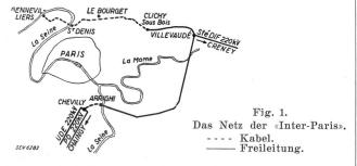
Die Studien führten zu dem seit 1936 im Betriebe stehenden, aus Kabel und Freileitung zusammengesetzten 220-kV-Netz gemäss Fig. 1. Das Netz weist folgende neuerstellte Hauptteile auf:
