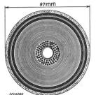
Fig. 2 (links). Schnitt durch das 220-kV-Oelkabel.
