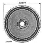
Fig. 2 (links). Schnitt durch das 220-kV-Oelkabel.
