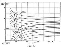
Prix d'équivalence (ets./kWh) en fonction de la durée d'utilisation (h) et du prix du coke (fr./t.), pour chauffage électrique direct et total, sans (variante I) et avec (variante II) accumulation de chaleur au moyen de l'énergie de nuit.
