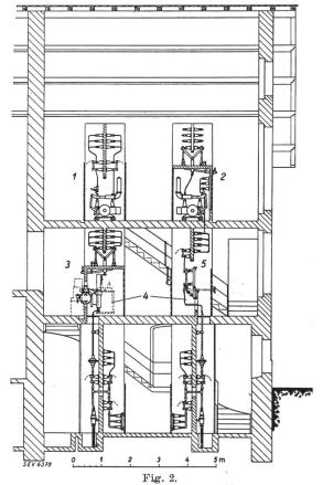
Querschnitt des Schalthauses.
