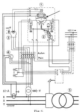
Réglage automatique de l'énergie réactive, par transformateur à prises supplémentaires, exécuté par MFO Zurich.
