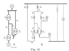
Principe de la mesure sur un modèle. a Schéma d'une ligne. b Schéma équivalent sur le modèle.
