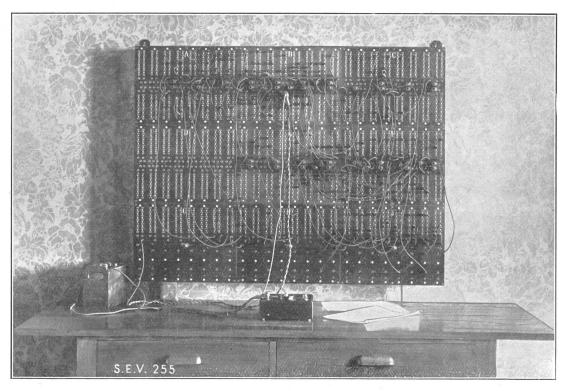
Fig. 12. Modèle de court-circuit de l'ASE.
