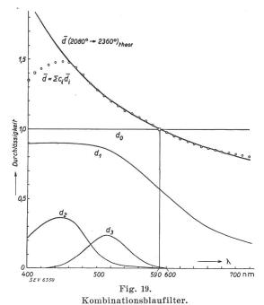
Einheitliche Filter, welche näherungsweise Schwarze Strahlungen ineinander umwandeln, sind die Kobaltblaugläser (Schott), die Wratten-Filter Typ 78 (Kodak), sowie einige in einer Arbeit von Estey <sup>8</sup>) zusammengestellte Filter.
