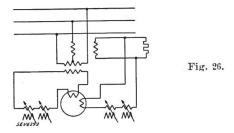
On pourrait obtenir aussi le même résultat en utilisant au lieu des machines en cascade, deux régulateurs d'induction par circuit, selon couplage de la fig. 26. Toutefois, le système de réglage serait également compliqué.
