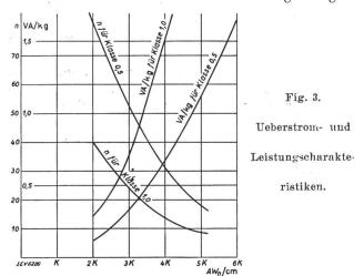
um so mehr hohe Ueberstromziffern und hohe Bürden verlangen kann. Dies ist keineswegs der Fall und steht im Widerspruch zum natürlichen Verhältnis der Dinge. Die Ueberstromziffer ist für eine schlechtere Messklasse und höhere Bürde um so kleiner. Relaiswandler haben deshalb eine geringe Ueberstromziffer, wenn sie wirklich nach der Bürde und Genauigkeit bemessen werden, für welche sie
