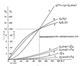
Fig. 5. Kennlinien für Motor und Drosselspulen. 1 Drosselspulenverluste (Spule x')
