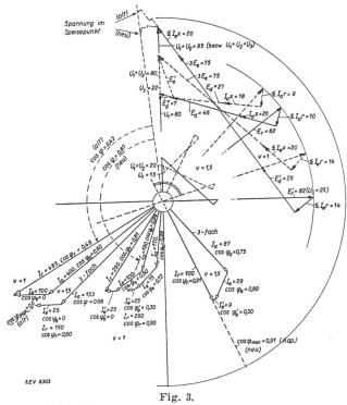
Vektordiagramm für alte und neue Schaltung. Vollast, Fahrgeschwindigkeit v=1; Min. Last, v=1,5. Ströme und Spannungen in %.
