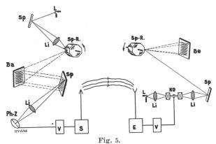
Principe de la télévision avec disque à facettes. L Source lumineuse. Sp Miroir. Li Lentille convergente. Ba Objet à explorer. Be Image reçue. Ph-Z Cellule photoélectrique. V Amplificateur d'image. S Emetteur haute fréquence. E Récepteur haute fréquence. E Optique de Kerr. E Disque à facettes.
