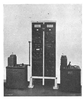
Fig. 3. Installation de télégraphie des images pour transmission par lignes téléphoniques. Dispositifs d'émission et de réception.
