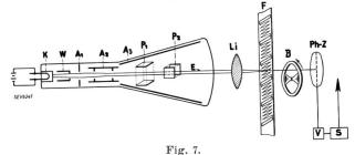
Principe du procédé à film intermédiaire avec tube à rayons cathodiques.
