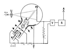
Fig. 8. Iconoscope utilisé pour la télévision.
