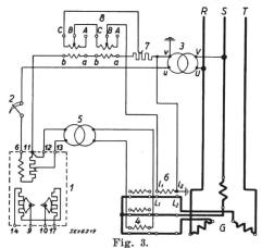
Prinzip-Schema der Generatoren-Anlage Handeck für die Kompoundierung der Spannungsregler.
