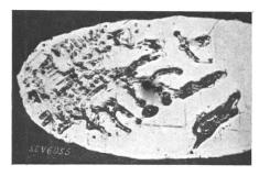
Fig. 7. Heizleiter-Längsschnitt, im Innern partiell geschmolzen.
