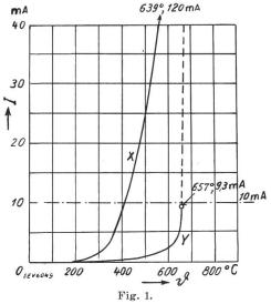
Ableitstrom I in Funktion der Kochplattentemperatur  $\vartheta$  bei Leergang und Prüfspannung 242 V,
