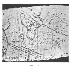
Fig. 6. Heizleiter-Längsschnitt mit Gefügeänderung, mässige Ueberhitzung.
