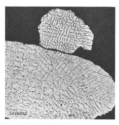
Fig. 5. Längsschnitt der Heizleiter Fig. 2 und 3.
