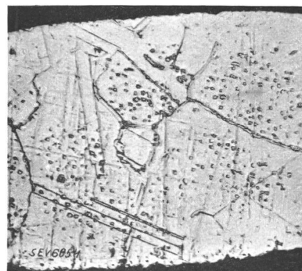
Fig. 6. Heizleiter-Längsschnitt mit Gefügeänderung, mässige Ueberhitzung.
