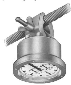
Fig. 6. Compteur d'oscillations fixé à un conducteur de ligne.
