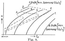
Regulierkurven für verschiedene  $U_a$  bzw.  $\ddot{u}$  bei stark gesättigtem Zwischentransformator vor dem Feld.
