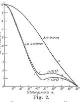
Gemessene Antennendiagramme verschiedener Antennen-Anordnungen mit gleichbleibendem Querschnitt des Strahlers.
