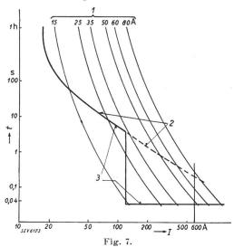
Zeit-Strom-Kurven von Sicherungen von 15, 25, 35, 50, 60 und 80 A und eines Selbstschalters von 15 A.
