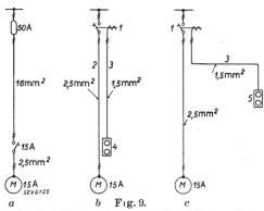
a Installation bei Verwendung von Hand-Motorschutzschalter.
