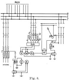
Schema für Erdschlussversuche mit Widerstandserdung einer Phase (R).
