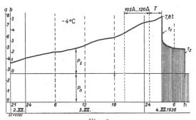
Fig. 8. Allure de la formation de givre dans la portée fig. 1, du 2 au 4 décembre 1936.
