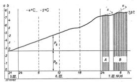
Fig. 2. Allure de la formation de givre dans la portée fig. 1, du 5 mars 1936, à 21 h, au 7 mars 1936, à 8 h.
