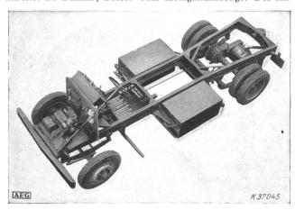
Fig. 2. Fahrgestell des 3-t-Lastwagens der AEG.
