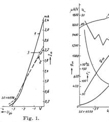
Graphische Bestimmung der Spannungskorrektur v einer Triode Typ 75. Kurve 1: Anodenstrom  $I_a$  in Funktion der Gitterspannung  $U_{00}$ .
