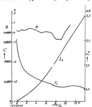
Fig. 3. Diodendaten in Funktion der Gitterspannung  $U_{\mathfrak{q}}$ Bezeichnungen s. Fig. 2. Typ 75;  $U_h = 6.3 \text{ V}.$
