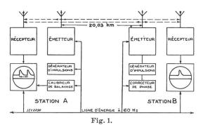
téristique. Un générateur d'impulsions, en série dans le circuit de polarisation rend positive la grille de la lampe amplificatrice une fois à chaque période du courant du réseau. L'impulsion est d'une durée de 0,0001 s. L'émetteur B, qui est également piloté par quartz, a fonctionné sur 1614 kHz et 2398 kHz avec une puissance de 100 W.
