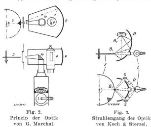
können. Marchal erreichte 1935, durch Einbau einer besseren Optik und eines Thyratrons eine einfachere Schaltung, da das Thyratron sich selbst unterbricht und die Relais R und M überflüssig macht. Eine weitere Verbesserung der Lichtausnützung brachten Koch und Sterzel durch Einbau eines rotationselliptischen Spiegels auf den Markt. Um die Fehler-
