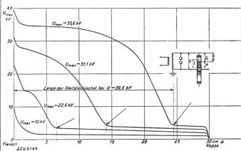
Fig. 5. Spannungsverteilung längs des Gleitrohres.
