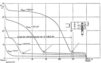
Fig. 5. Spannungsverteilung längs des Gleitrohres.
