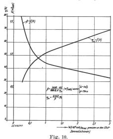
Wasserbedarf und Gesamtwirkungsgrad des Spullerseewerkes in Abhängigkeit von der monatlichen Energieerzeugung.
