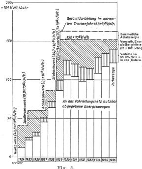
Fig. 3. Entwicklung des Energiebedarfes.
