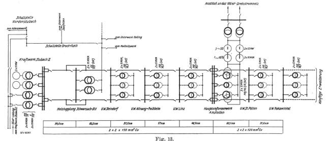
Schaltbild der geplanten Einphasensammelschiene für die Versorgung der Strecke Salzburg-Wien.
