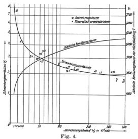
Schwankungsverhältnis und Benützungsdauer der Höchstleistung in Abhängigkeit vom Energiebedarf.
