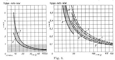
Coût unitaire x du transport d'énergie pour la puissance nominale (courbes 1) et pour la puissance économique (courbes 2), en fonction de la tension au départ U.
