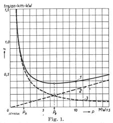
Coût unitaire x du transport d'énergie, par une ligne à 32 kV,  $3\times70$  mm², en fonction de la puissance maximum au départ P.
