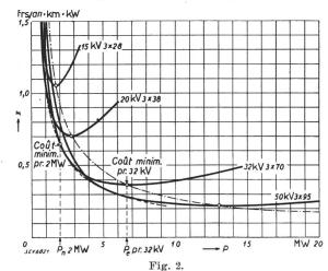
Coût unitaire x du transport d'énergie, compte tenu des pertes, en fonction de la puissance maximum P transmise au départ.
