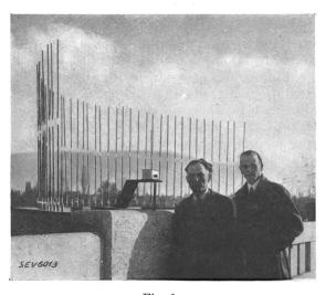
Fig. 6. Un réflecteur de 3 m d'ouverture, avec, au foyer, l'oscillateur. Cet équipement permet la téléphonie dirigée à plus de 100 kilomètres de distance.
