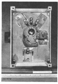
Fig. 5. L'oscillateur ouvert. On distingue le miniscule circuit oscillant soudé directement aux brochettes de la 955.
