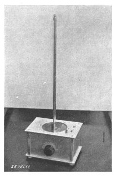
Fig. 4. L'oscillateur (contenant une 955) surmonté de son antenne demi-onde.
