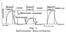
ausschlag hinausschwingt. Im Zeitpunkt des Durchgangs durch den Höchstwert wird die Zelle wieder verdunkelt. Nach Rückkehr des Lichtzeigers auf Null und Nachkontrolle des Nullpunktes wird Beleuchtung B eingeschaltet usw., wie in Fig. 2 ange-
