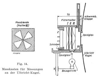
schnitte ist so gewählt (s. Fig. 14), dass die Richtungsverteilung der Bestrahlung der Filter und der Zelle für alle Blenden ungefähr gleich ist. Dies hat den Vorteil, dass bei allfälliger gleichzeitiger Benutzung von Graugläsern und Blenden die Durchlässigkeit der Graugläser von der Grösse der Blendenöffnung nicht abhängt. Ferner kommt es bei der Eichung, bei welcher der Kasten als Ganzes, einschliesslich das Eintritts-Opalfenster, auf die Bank
