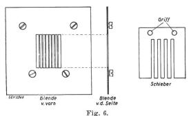
Halbierungsblende mit feinerer Struktur für Messungen mit monochromatischem Licht.
