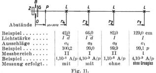
Beispiel einer Prüfung des  $\frac{1}{r^2}$  – Gesetzes.
