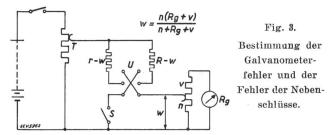
abgenommene Klemmenspannung bleibt beim Umlegen des Umschalters U nahezu konstant. Als Teiler kann der für die Einstellung der Lampenströme dienende Kompensationsapparat verwendet werden (Sonderausführung Trüb, Täuber & Co. A.-G., für photometrische Zwecke mit 2000 Ohm Gesamtwiderstand).
