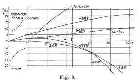
Abweichungen vom Proportionalitätsgesetz bei Selen-Sperrschichtzellen. Beispiel: Der zur Beleuchtung 2 lx gehörige Strom, bezogen auf den zur Beleuchtung 20 lx gehörigen Strom, füllt bei Westonzelle Nr. 2271 zu klein aus und ist mit 1,007 zu multiplizieren.
