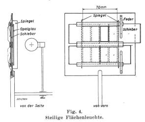
des Fenster einzeln als Lichtquelle freigelassen werden. Durch zwei ebenfalls auf der Rückseite angeordnete Spiegel kann erreicht werden, dass alle Fenster ungefähr gleich lichtstark sind.
