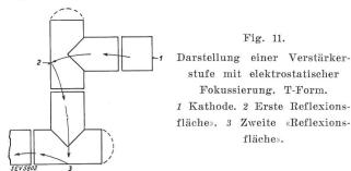
Bei der Steuerung der beschriebenen Verstärker durch eine bestimmte Eingangsspannung statt durch Licht treten ihre Vorteile weniger zutage, da durch die dazu nötige Einführung einer Koppelungsimpedanz das thermische Rauschen wieder auftritt genau wie bei normalen Thermionen-Verstärkern. — (V. K. Zworykin, G. A. Morton and L. Malter. Proc. Inst. Radio Engr. Vol. 24 [1936], Nr. 3, p. 351.) Hdg.
