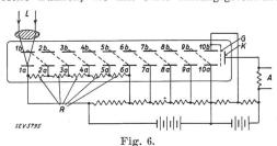
«Photoröhre.» L einfallendes Licht. R Innen-Widerstände. G Gitter. K Kollektor. A Ausgang.
