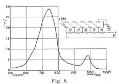
Abhängigkeit des Ausgangsstromes (I) von der Gesamtspannung  $(U_{\text{tot}})$ . Die gestrichelten Linien im Schema bedeuten Verbindungen innerhalb der Röhre.
