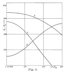
Synchronisierende Leistung einer Synchronmaschine mit ausgeprägten Polen und Dämpferwicklung, bei verschiedenen Werten des stationären Polradwinkels  $\delta_0$ .
