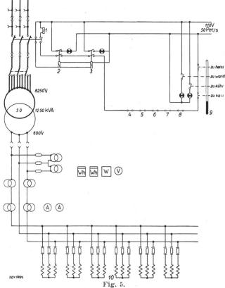
Schéma de principe de l'installation de séchage des marcs.
