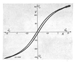
Fig. 18. Photographische Aufnahme der Magnetisierungscharakteristik einer fremderregten Gleichstromdynamomaschine.
