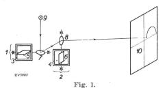
Schematische Darstellung des verwendeten Messgerätes. 1, 2 ferrodynamische Messwerke; 3, 4 feste Spulen; 5, 6 Drehspulen; 7, 8 Spiegelchen; 9 Lichtquelle; 10 Projektionsfläche.
