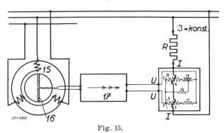
Schaltbild der Versuchsanordnung zur Aufnahme des Görgesschen Durchflutungspolygons einer Drehstromwicklung.
