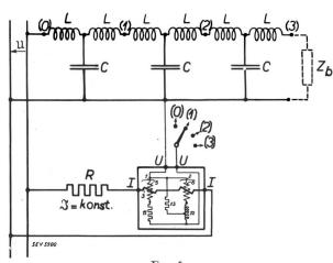
Fig. 5. Schaltbild einer künstlichen Leitung: L Induktivitäten, C Kapazitäten,  $Z_b$  Bürde am Ende der künstlichen Leitung.  $1 \dots 6$ ,  $11 \dots 13$  hat die gleiche Bedeutung wie in Fig. 1 bzw. 2. II sind die Stromklemmen, UU die Spannungsklemmen des Messgerätes.
