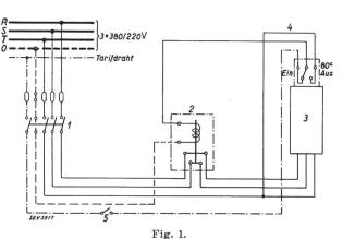
Schema zur Steuerung von Heisswasserspeichern durch Tarifdraht.
