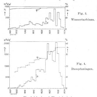
Fig. 3 (oben) und Fig. 4 (unten). Alter und höchste Wirkungsgrade der installierten Maschinen der öffentlichen Werke.
