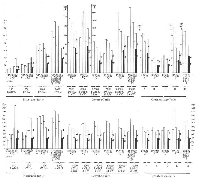
Fig. 63 (oben) und 64 (unten). Vergleich der Energiekosten einiger typischer Bezüger bei Verrechnung der Energie nach EKZ-Tarif und nach verschiedenen amerikanischen Tarifen.
