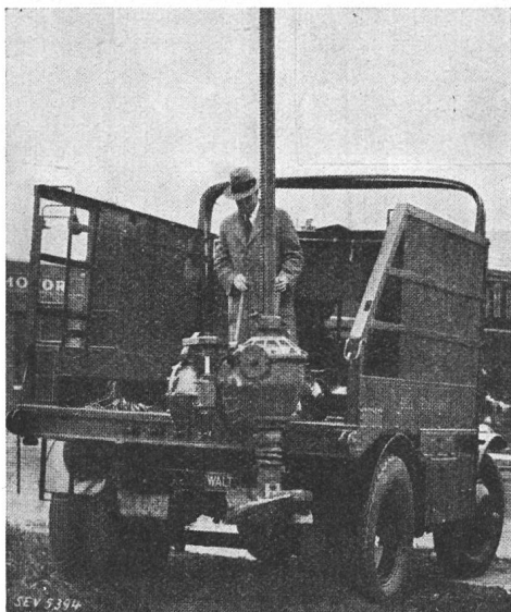
Fig. 39. Automobil mit Mastlochbohrer. (Der Bohrer kann gekippt werden.)
