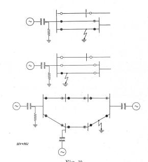
Fig. 10. Exemples de signalisation d'un défaut à la terre par relais de terre.
