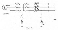
Versuch zur Demonstration der Erdschlußstrom-Kompensation. Netzspannung 10 kV.
