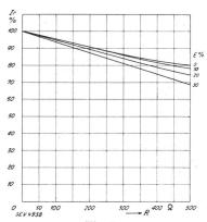
Fig. 5. Influence de la résistance de passage R au défaut sur le courant résiduel Ir.
