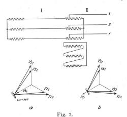
Couplage de réseaux par autotransformateur.
