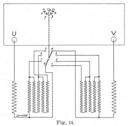
Disposition des enroulements à prise d'une bobine d'extinction.
