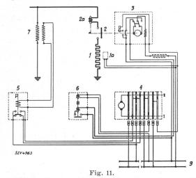
Dispositif d'enclenchement et de déclenchement automatiques de la résistance au point neutre.
