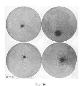
Exemples de figures de Lichtenberg relevées dans les appareils de mesure de la raideur.
