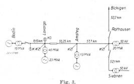
Schéma de principe du réseau observé à 150 kV.
