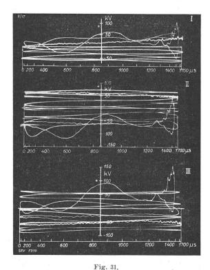
Deuxième exemple d'oscillogramme d'une surtension due à la foudre n'ayant pas causé de perturbation de service.
