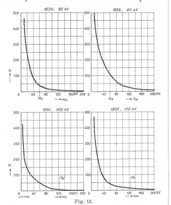
Diagrammes de la fréquence des surtensions atmosphériques de différentes valeurs, établis d'après les mesures faites à l'oscillographe cathodique de Lavorgo.
