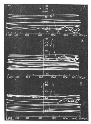
Quatrième exemple d'oscillogramme d'une surtension due à la foudre n'ayant pas causé de perturbation de service.
