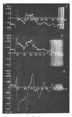
Fig. 19. Oscillogramme de la perturbation a). Les phases du réseau triphasé sont désignées par I, II, III.
