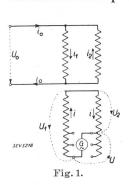
par une tension fixe que nous supposons être celle d'un réseau. Les deux secondaires sont couplés en parallèle par l'intermédiaire d'une machine synchrone dont la tension aux bornes est u. Un montage tout à fait analogue peut naturellement se concevoir en triphasé.
