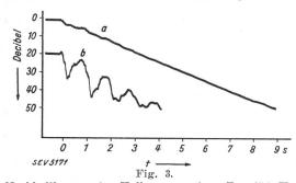
Nachhallkurven im Halbraum; reiner Ton 87,8 Hz. ve a: Mikrophon im Druckbauch; Kurve b: Mikrophon im Druckknoten. Kurve a: Mikrophon
