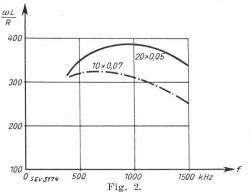
Einfluss des Litzenaufbaues auf die Güte der Spule.
