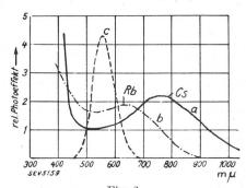
Fig. 2. Spektrale Empfindlichkeitsverteilung der verwendeten Kathoden.
