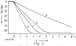
Abklingkurve einer Stimmgabel: a ohne zusätzliche Dämpfung, b mit Radiergummidämpfung, c mit Korkdämpfung, d mit gummiartiger Masse gedämpft.
