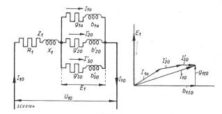
Ersatzschaltung des Streutransformators bei Leerlauf mit Stromdiagramm zur exakten Bestimmung der Leerlaufadmittanz.
