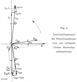
an, sondern es muss das Verhältnis der EMKe des Streu- und Sekundärkreises mitberücksichtigt werden. Bei Leerlauf lässt sich mit diesen Beziehungen auch das Diagramm der Ströme, Spannungen und Wechselkraftflüsse aufstellen (Fig. 6). Aus dem Diagramm ergibt sich das ausgewertete Verhältnis der Spannungen und der Kraftflüsse
