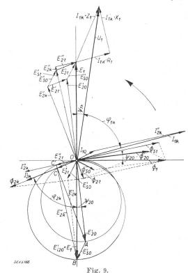
Vollständiges Diagramm des Streutransformators bei Kurzschluss.
