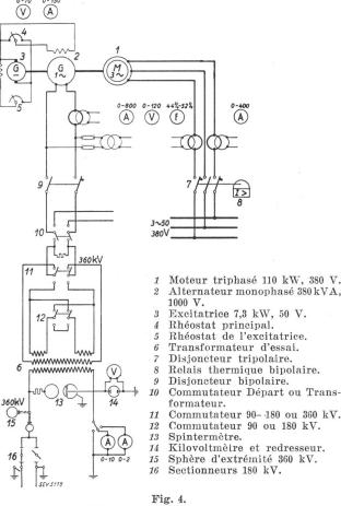
Schéma de la station à 360 kV.
