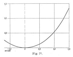
prescrite, on déplace la sécante parallèlement à elle-même et l'on répète le procédé jusqu'à ce que la tension obtenue corresponde à la valeur choisie. Quand c'est le cas, le paramètre cherché est égal au paramètre de la courbe type multiplié par  $\frac{x}{b}$  et l'arc de cette courbe coupé par la sécante est la représentation de la courbe cherchée à l'échelle 1:  $\frac{x}{b}$ .
