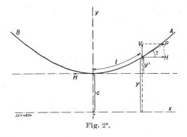
ducteurs devient alors une chaînette. En effet, selon la figure  $2^*$ , où H est la composante horizontale et V la composante verticale de la tension P dans le conducteur, on a:
