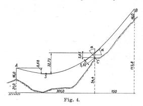
maximum ne dépasse pas le 85 % de la valeur maximum admissible de 1800 kg/cm² prescrite par l'Ordonnance. Il s'agit de déterminer quelle est la distance entre le conducteur et le point C du terrain (bord extérieur de la route) à 0° C et 2 kg/m de neige.
