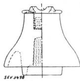
Fig. 5 (oben) und Fig. 6 (rechts). Konstruktion und Prüfresultat eines 20-kV-störungsfreien Isolators.
