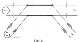
Transmission simultanée d'énergie sous forme de courant continu et de courant alternatif par une même ligne.
