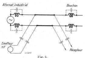
Transmission simultanée d'énergie sous forme de courants alternatifs de fréquences différentes.
