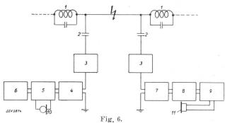
Schéma de principe d'une transmission téléphonique. 1 Bouchon. 2 Condensateur de couplage. 3 Protection. 4 Poste émetteur. 5 Modulateur. 6 Générateur HF. 7 Filtre. 8 Amplificateur. 9 Détecteur. 10 Microphone. 11 Téléphone.
