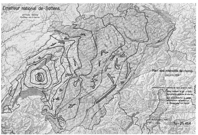
Ausbreitung der Bodenwellen des Landessenders Sottens, 677 kHz, 100 kW. Maßstab 1:2000000. Sommer 1936.
