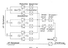
Fig. 2. Schematischer Gesamtaufbau des C-Systems.
