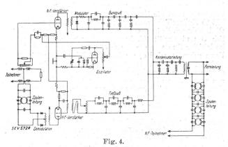
Prinzipschaltung eines vereinfachten Einkanal-Trägerstromsystems.
