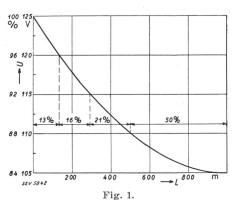
Chute de tension en fonction de la distance, et répartition des lampes suivant la tension.
