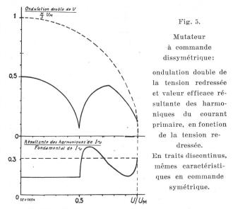
tion double de la tension redressée, et à la partie inférieure la valeur efficace résultante de tous les harmoniques du courant primaire. On constate que les harmoniques du courant primaire sont fortement réduits pour les réglages de tension inférieurs à 20 % ou supérieurs à 50 %.
