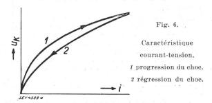
tance d'un tel limiteur de tension est plus faible lors de la régression du courant que lors de l'accroissement du courant qui la précède immédiatement. La durée du courant de choc ne doit pas être choisie trop brève pour ces mesures, surtout s'il s'agit de parafoudres présentant des résistances de ce genre; elle doit correspondre à l'onde d'essai normale resp. à la durée de mi-amplitude normale. Les deux résultats (fig. 5 et 6) peuvent être ramenés l'un à l'autre par le calcul, en considé-
