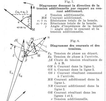
additionnelle e. Cette tension est décalée en avant par rapport au courant MR d'un angle  $\gamma$  donné par  $(r_1+r_2)$  et  $(x_1 + x_2)$ , voir fig. 7.
