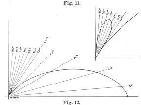
Dem Nullwinkel, welcher sich für Fig. 12 bestimmt aus  $\cos\left(\frac{2\,\pi}{\lambda}\left(\frac{l}{2}-x\right)\sin\,\varphi\right)=0$ , wo h die resultierende effektive Höhe bedeutet, entspricht in Fig. 10 u. 11 ein Feldstärkeminimum  $\frac{\mathrm{d}}{\mathrm{d}\varphi}\,(\varphi)=0$ . In der erwähnten Arbeit von Berndt und Gothe 3) sind ähnliche Resultate angegeben.
