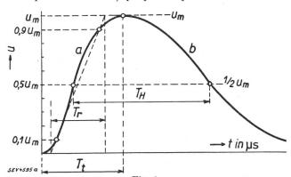
Fig. 1. Eléments caractéristiques du choc de tension. a front; b queue.
