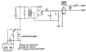
Fig. 1. Grundsätzliches Schema des Geräuschwertzeigers.
