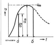
Fig. 2. Contournement par choc. a contournement dans front du choc. b contournement dans la
