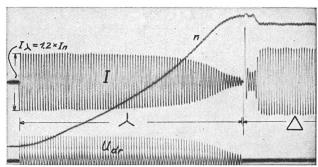
Erzieltes Anlaufoszillogramm des echten Käfigankers. I Strom in der Zuleitung. n Motordrehzahl.  $U_{\mathrm{dr}}$  Drosselspulenspannung.
