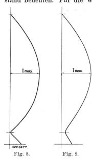
den sich in der Literatur Angaben 5). Als Wellenwiderstand sei  $Z_A = 210$  Ohm gewählt. In den Fig. 8 und 9 sind die gefundenen Stromverteilungen für eine Mitte- und Fuss-gespeiste Antenne dargestellt (nach den Gl. (2) und (5), wobei  $I_{max}$  in beiden Fällen gleich gewählt wurde). Der grössere Knotenstrom bei der Fuss-gespeisten Antenne ist augenfällig. Den beiden Figuren entsprechen die Vertikaldiagramme Fig. 10 und 11, wo sich der verschiedenen Grösse
