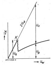
Tension aux bornes du parafoudre en fonction de l'amplitude de l'onde d'essai.
