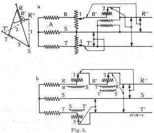
Réseau avec triangle des tensions asymétrique et variable, et trois transformateurs de réglage dans deux phases
