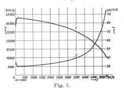
Vitesse et durée de transmission pour un circuit réel chargé par des bobines de 44 mH espacées de 1830 m.
