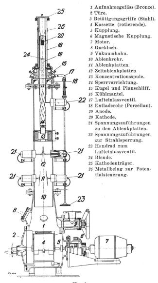
Fig. 6. Schnitt durch einen konstruktiv durchgebildeten Kathodenstrahloszillographen.
