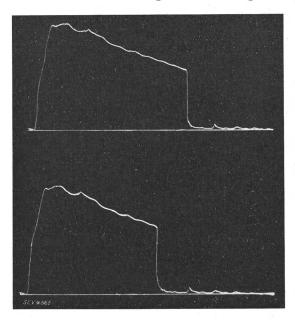
Fig. 15. Ueberschlagsverzug eines Durchführungs-Isolators.
