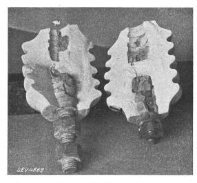
Fig. 16. Durchschlag eines Stütz-Isolators bei der Stossprüfung.
