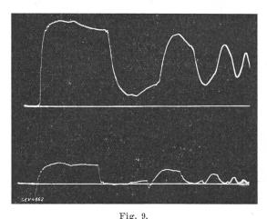
Einschaltwelle (oben) und Influenzwelle (unten) zwischen einem Leitungsseil und Erde einer 900 m langen Freileitung.
