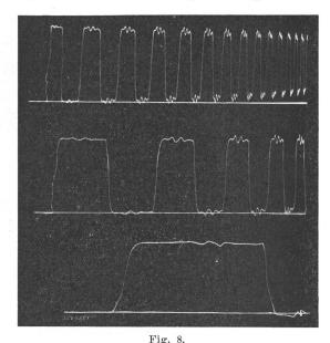
Symmetrische Einschaltwelle zwischen 2 Seilen einer 900 m langen Freileitung. Periodendauer der Wellenschwingung = ca. 12 µs. 3 verschiedene Zeitmaßstäbe.
