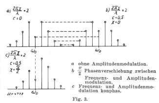
Veränderungen eines Heultonspektrums durch zusätzliche Amplitudenmodulation.
